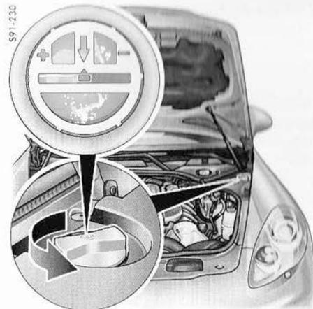
1. Relevez le niveau d'huile moteur sur l'écran multifonction, avant d'ouvrir le capot moteur. Pour plus d'informations sur la mesure du niveau d'huile :
